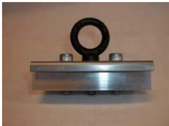
図 62 ボルト D リングアンカープレート 1/2"-13 TPI UNC 1-1/2" ロンググレード 8 ソケットヘッドキャップネジとロックワッシャー (トルク 40 フィートポンド) で取り付けられている
