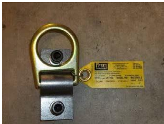
図 62 ボルト D リングアンカープレート 1/2"-13 TPI UNC 1-1/2" ロンググレード 8 ソケットヘッドキャップネジとロックワッシャー (トルク 40 フィートポンド) で取り付けられている
